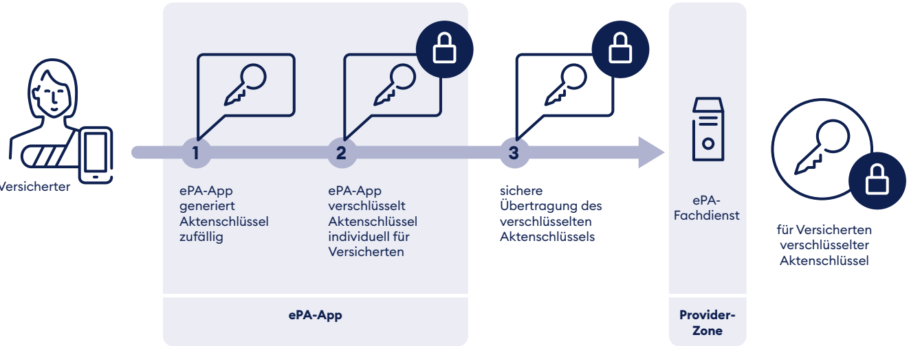
Abbildung 11 – Generierung des versichertenindividuellen Aktenschlüssels bei der Eröffnung der elektronischen Patientenakte
